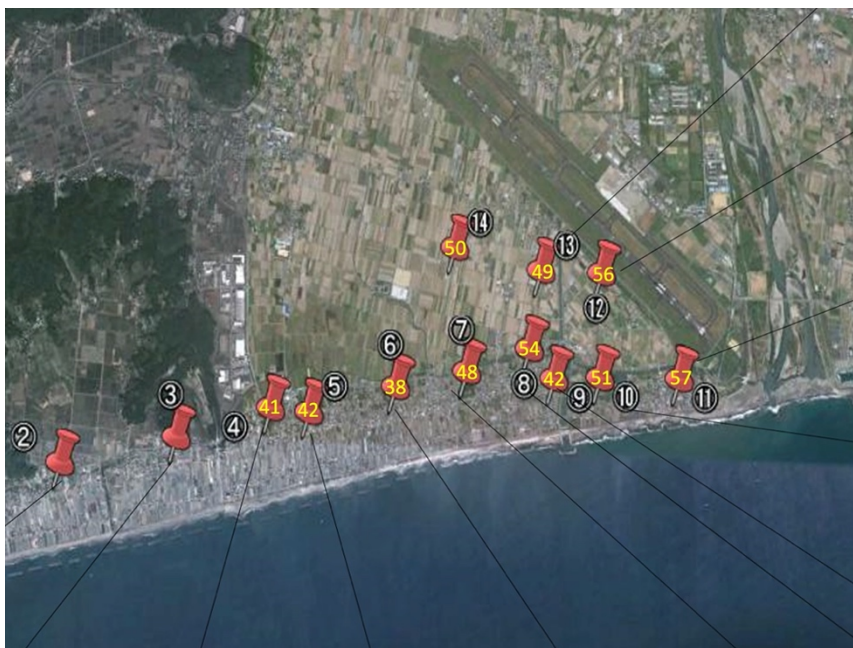
図5 南国市役所との LoRa 通信ができた津波避難タワーの位置にオレンジ色の文字で電波強度に対応する RSSI に相当する値を記入
