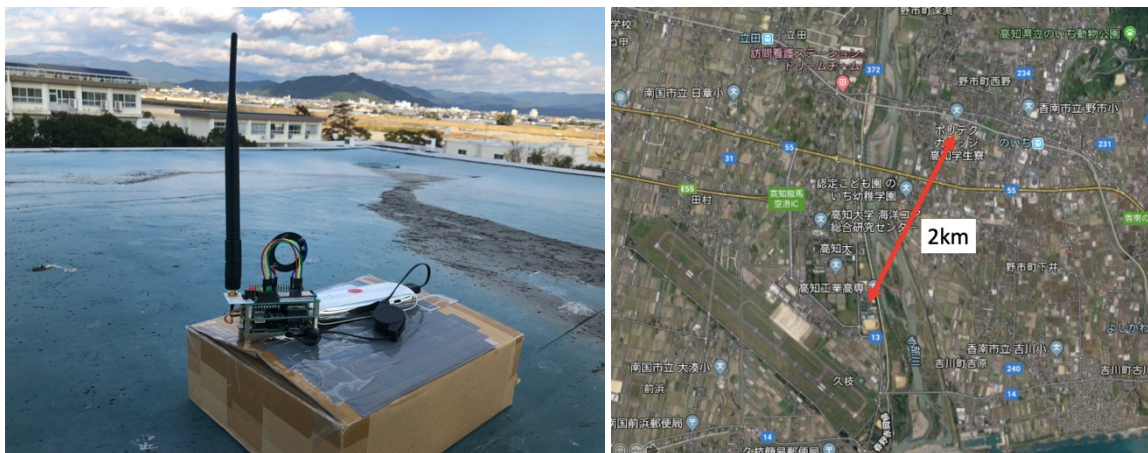
図 3 左の写真（ポリテクカレッジ高知方向）は、高知高専・電気情報工学科棟の屋上に仮設した LoRa 親機（モバイルバッテリーで電源供給）で、右は高知高専とポリテクカレッジ高知の地図上の位置関係と距離を示している。
