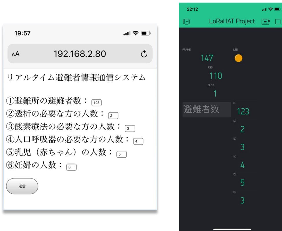
図7 左は、避難者情報を入力する人のスマートフォン（LoRa 子機に無線 LAN 接続）の画面で、右は LoRa 親機と連動する Blynk アプリの表示画面
